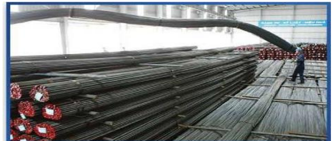
Thép thanh vằn từ D10 - D32 Deformed bar: size ranging from D10 to D32
